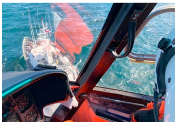
Vista del piloto del helicóptero hacia la LSG, encontrándose en vuelo estacionario en posición segura para maniobra Hi-Line.
