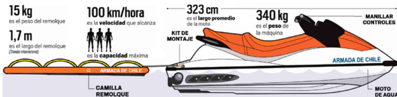
Figura 3. Infografía Moto Acuática GTI 130 HP y camilla de remolque 1 .
