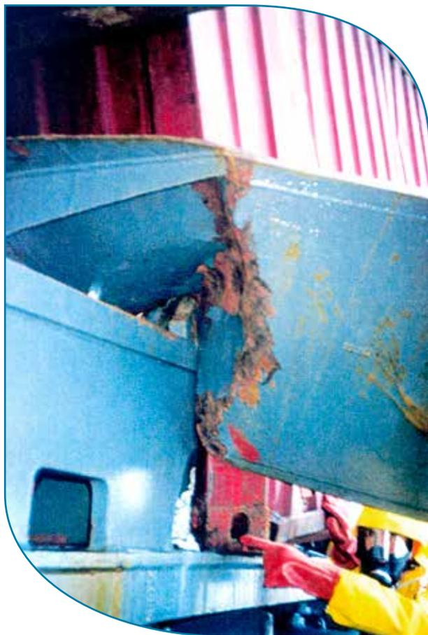
Carga expuesta del contenedor cargado y colapsado en cubierta entre bodegas 2 y 3 por babor.
