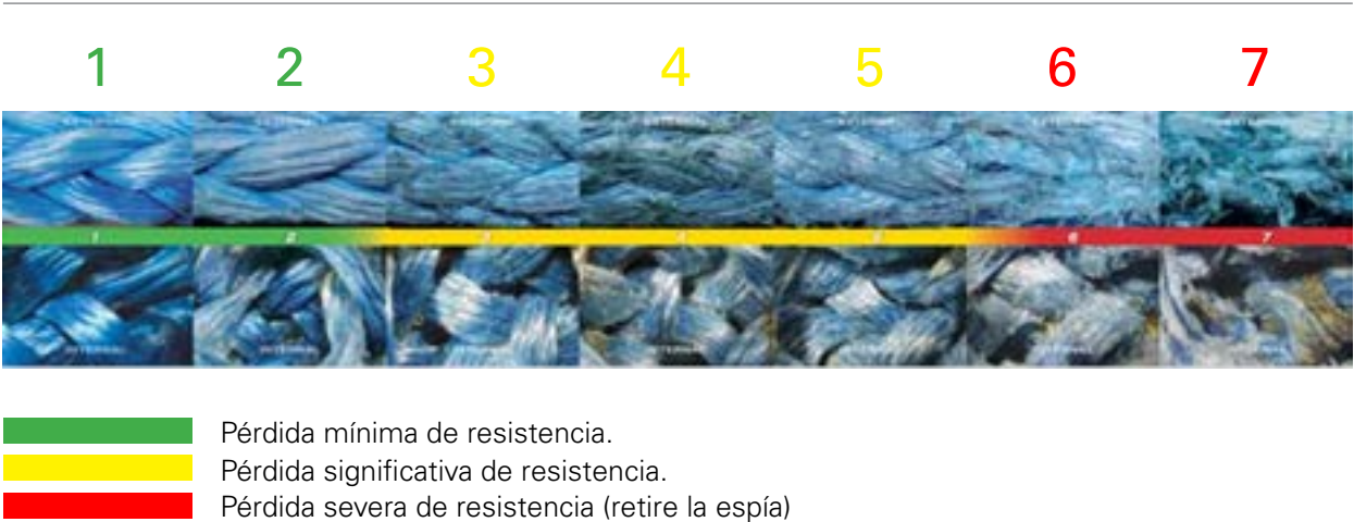
Fig. 1: Guía de terreno para inspección de espías (Fabricante Samson).
