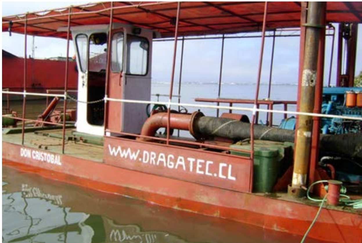
Draga de tipo succión utilizada para dragado del área.
